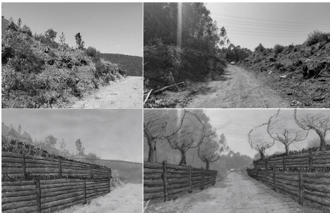
Figura 52 - Situação existente (em cima) e proposta (em baixo) com técnica de bioengenharia (paliçada) junto ao caminho. Fotografias e ilustrações de autoria própria.
