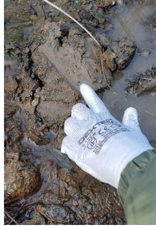
Figura 37: Verificação de que o solo era de facto argiloso, com boa capacidade de retenção de água. Fotografia de autoria própria.
